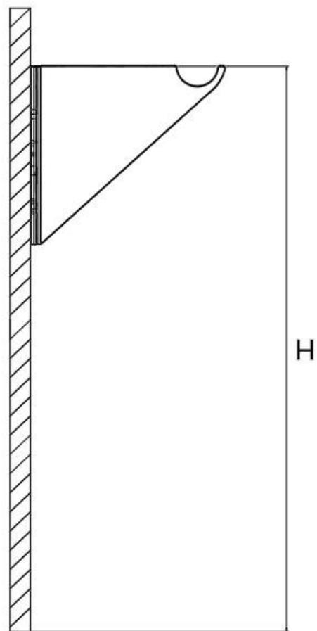
3. Markieren Sie die gewünschte Höhe mit einer Wasserwaage und einem Bleistift und bohren Sie an den Punkten mit einem Bohrer und einem 8mm-Bohrer ein Loch.
