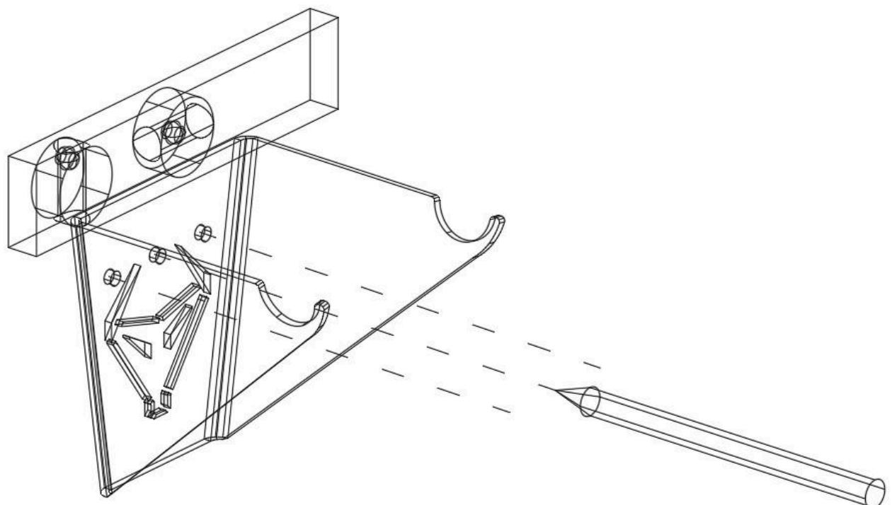
4. Stecken Sie die Dübel in die Löcher, die Sie gerade gemacht haben, und schrauben Sie dann die Halterung an die Wand, indem Sie die Schrauben durch die Löcher führen.
