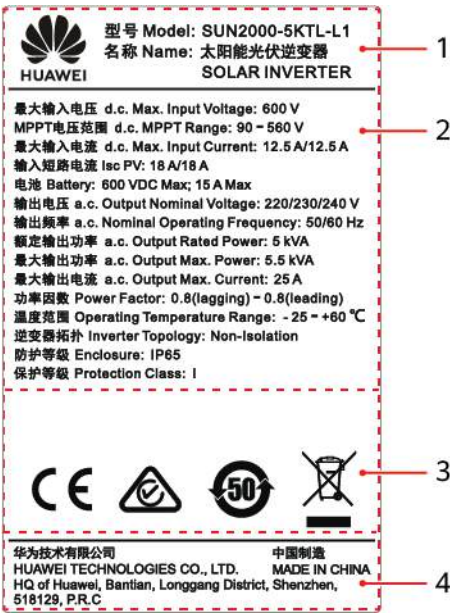
Figure 2-6 Plaque signalétique (SUN2000-5KTL-L1 utilisé à titre d'exemple)
