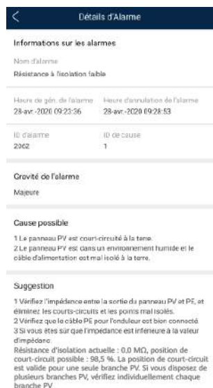
Figure E-1 Détails d'alarme
