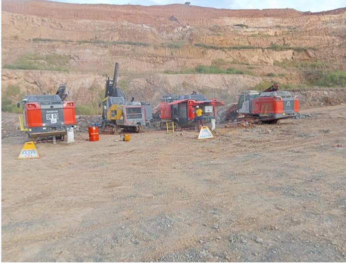
Nous avons réalisé le forage des trous de production de diamètres compris entre **115 mm** et **140 mm**.
