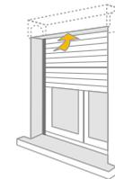
Le coffre tunnel est équipé d'un volet roulant qui s'intègre directement dans le bâti maçonné. Avec son caisson polystyrène haute densité, il présente de **bonnes performances d'isolation thermique et phonique.**
