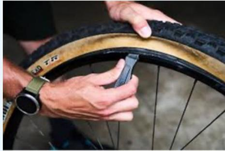
Figura 5. Utilizzo delle leve per pneumatici
