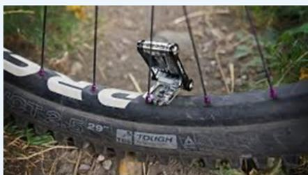
Figura 10. Uso de una llave de radios
