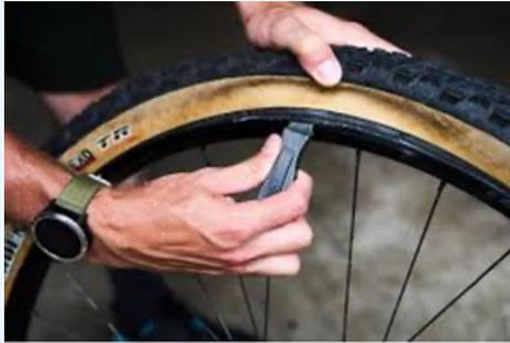
Figura 5. Uso de palancas para neumáticos
