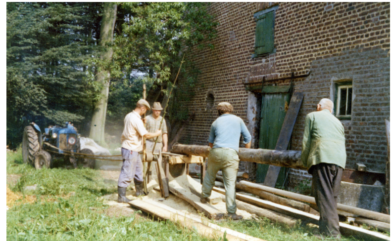
Afb. 24. Het doorzagen van lange boomstammen bij de paardenstal van de schuur. Een Ford Major drijft een zaagmachine aan. Gerard (met hoed), Léon (met stok tegen de poelie), Henk en vader Sef Peters op 1 juli 1965 (Partic. Coll.).
