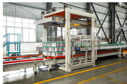
自动码垛、缠绕膜、打包机 Automatic pallet packaging machine
