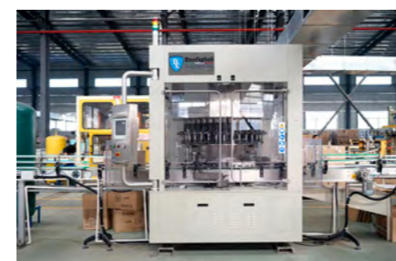
意大利 Bonfiglioli36 工位气密性检测机 Bonfiglioli leak testing machine
