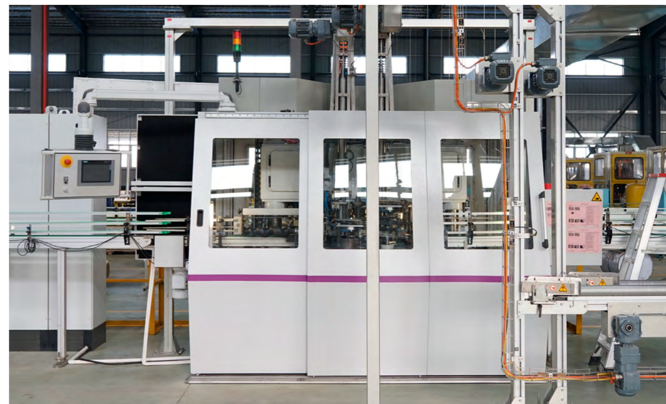
瑞士 Soudronic 全自动电阻焊接机 Soudronic welding machine
