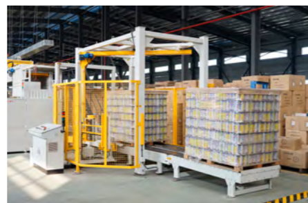
自动码垛、缠绕膜、打包机 Automatic pallet packaging machine
