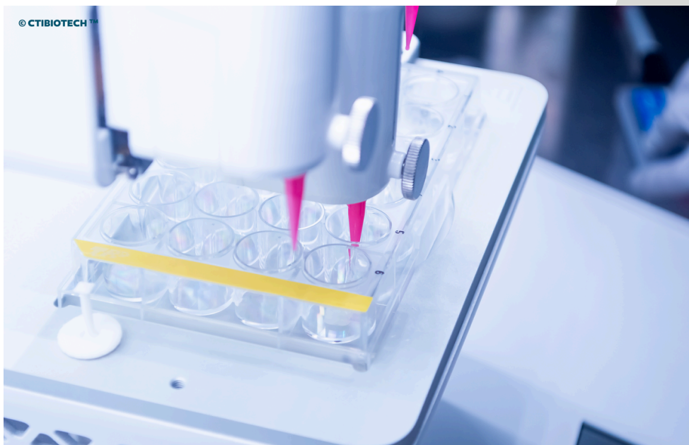
Figure 3 : Bio-impression 3D automatisée de microtumours pancréatiques dans un format standardisé de plaque à 24 puits pour les essais de médicaments.
