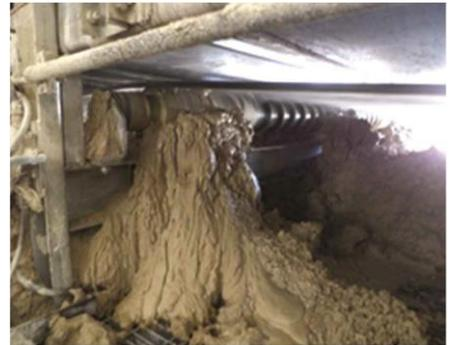
*Acúmulo de material em uma trajetória de retorno do transportador devido ao transporte excessivo*
