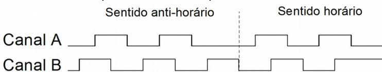
Já na figura ao lado, podemos identificar o sentido de rotação do motor, observando os canais A e B do motor. Analisando a imagem na escala em função do tempo, podemos perceber que se a sequência de pulsos é B → A, o encoder gira para um lado, A → B
