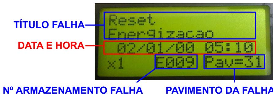
O MINILEV armazena até 101 falhas. Para apagá-las, basta apertar a tecla de reset:
