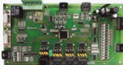
A placa seletora define com precisão a melhor velocidade e o ponto ideal para início da parada, pois recebe através do encoder a velocidade instantânea e a posição do elevador.
