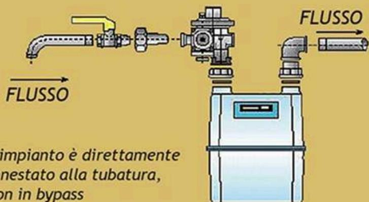
L'impianto è direttamente innestato alla tubatura, non in bypass
