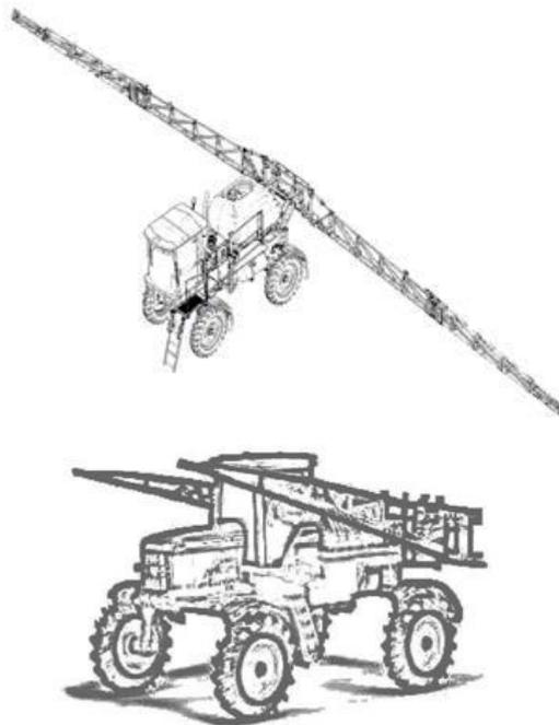
**Pulverizador tracionado:** implemento agrícola que, quando acoplado a um trator agrícola, pode realizar a operação de aplicar agrotóxicos.
