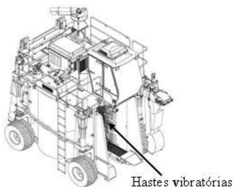
**Colhedora de cana-de-açúcar:** equipamento que permite a colheita de cana de modo uniforme, por possuir sistema de corte de base capaz de cortar a cana-de-açúcar acompanhando o perfil do solo. Possui um sistema de elevador que desloca a cana cortada até a unidade de transbordo.
