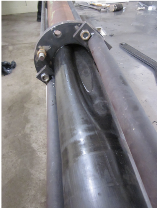
(a) 'Liner' colapsado mientras se extrae del equipo.
