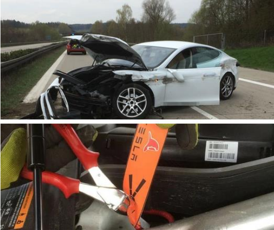
صورة توضيحية لموقع قطع دائرة الجهد العالي في سيارة كهربائية
