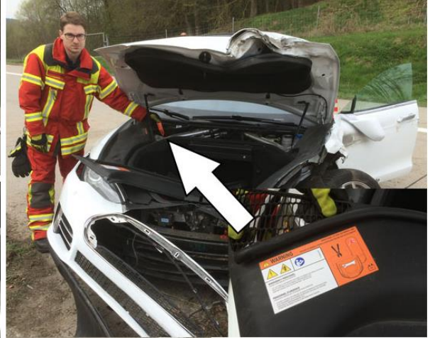
صورة توضيحية لموقع قطع دائرة الجهد العالي في سيارة كهربائية
