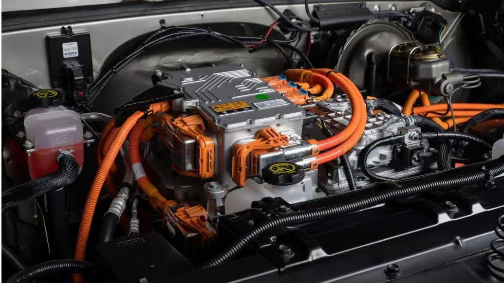
صورة توضيحية لموقع المحول/العاكس في سيارة كهربائية
