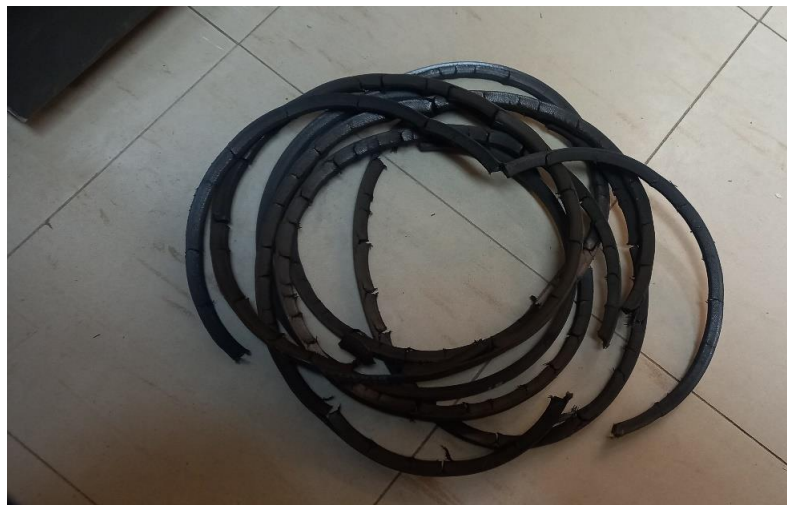
Se registró fajas de transmisión en mal estado
