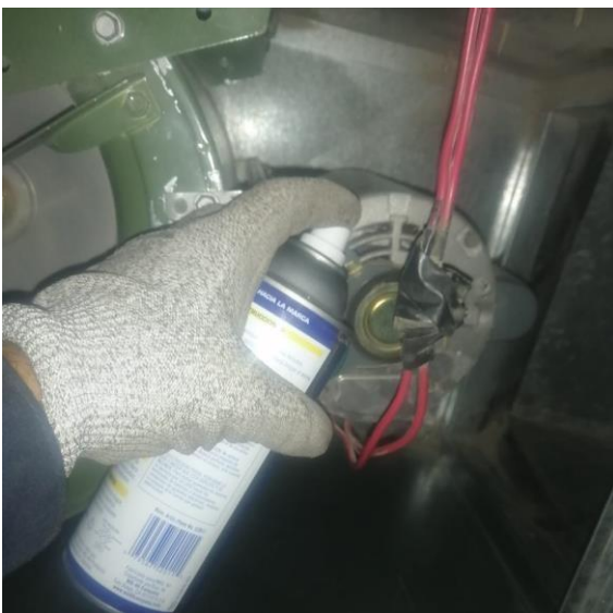
Se lubrico partes móviles del motor eléctrico
