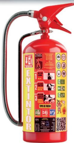
EXTINTORES P.Q.S, CILINDRO FABRICADO EN LAMINA NEGRA CAL. 14, VALVULA PERFIL ALUMINIO ¾" O 1" TOTALMENTE NUEVOS, CARGADOS CON POLVO QUIMICO SECO TIPO ABC CERTIFICADO. LA RECARGA DE ESTOS EQUIPO SE REALIZA CON P.Q.S. NUEVO Y CERTIFICADO CON COLOR VIGENTE DE ACUERDO A LO ESTABLECIDO EN DOF, INCLUYE CAMBIO DE O"RING DE VALVULA REVISION INTERNA DEL CILINDRO, DE LA VALVULA Y TODOS SUS COMPONENTES, POR ULTIMO SE PRESURIZAN A 1.2 O 1.7 PSI SEGÚN CORRESPONDA LA CAPACIDAD DEL EXTINTOR
