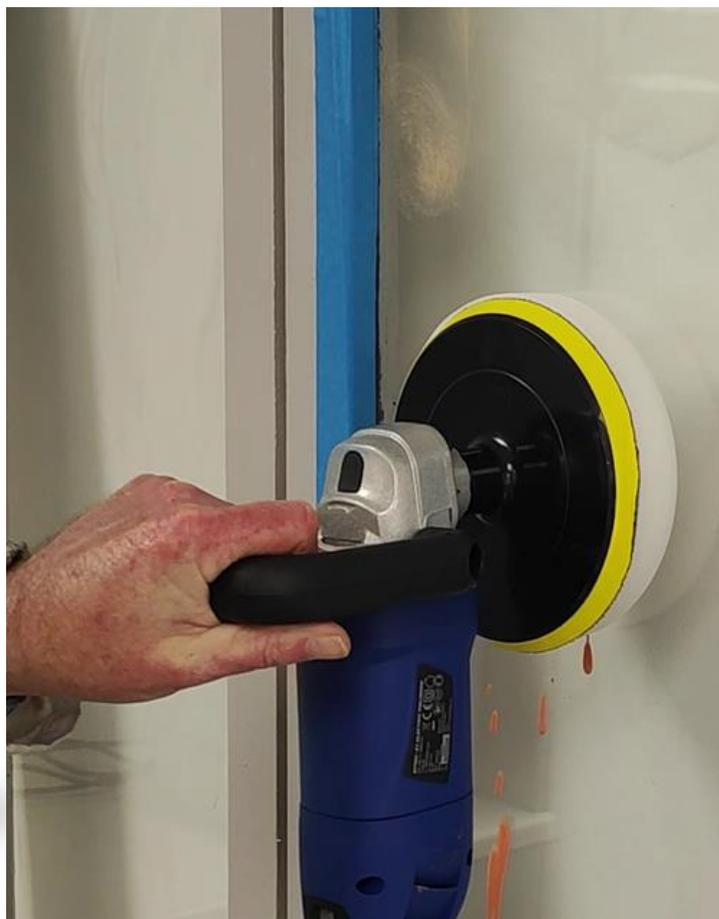
Utiliser la polisseuse sur des surfaces de verre importante. Utiliser le tampon pour les petites surfaces.
