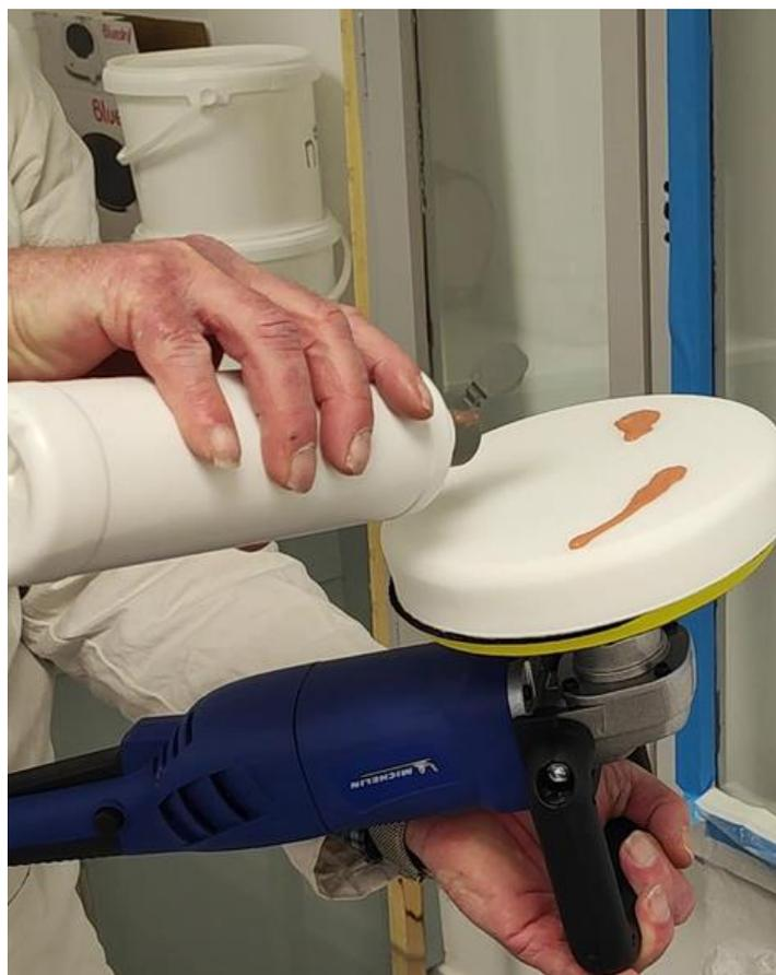
Verser la solution de polissage sur le disque de la polisseuse ou sur le tampon de polissage.
