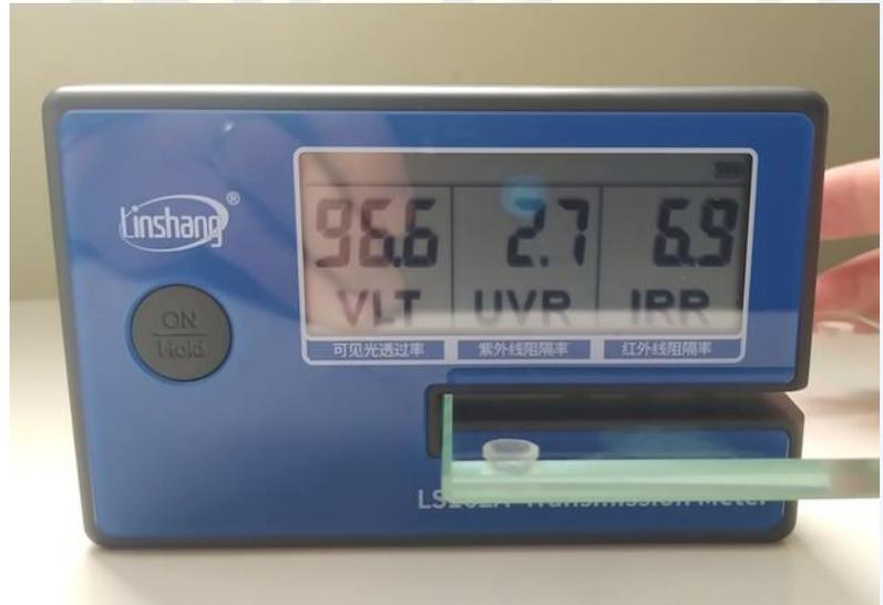
La vitre test bloque naturellement : 2.7% des UV et 6.9% des IR
