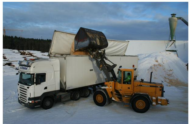
FIGURE 9.23 – La sciure de bois, produite en très grande quantité dans l'industrie, peut être utilisée comme source d'énergie dans une centrale à vapeur.
