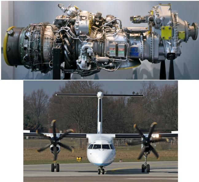
FIGURE 10.26 – Un turbopropulseur *Pratt & Whitney Canada PWC123* équipant un *Bombardier Dash 8*. Le PWC123 est équipé de deux arbres et d'une turbine libre, mais son agencement de principe reste similaire à celui décrit en figure 10.25.
