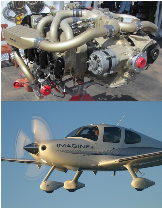
FIGURE 10.28 – Moteur six cylindres essence injection Continental IO-550 de 300 ch, en fabrication depuis 1983. Il équipe entre autres le Cirrus SR22.
