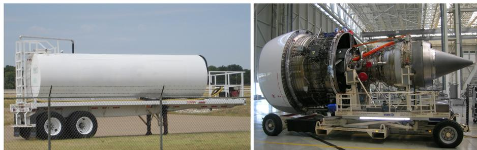
FIGURE 1.2 – Une remorque, de puissance nulle ( $\dot{Q} = 0 \text{ W}$ ) mais capable de restituer beaucoup d'énergie. La combustion de 20 t de kérosène dégage environ  $Q = 900 \text{ GJ}$  sous forme de chaleur ;
