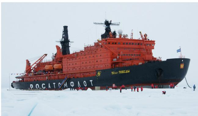
FIGURE 9.24 – Le 50 Let Pobjeda, brise-glace de 25 000 t à propulsion nucléo-turbo-électrique (deux réacteurs de  $171\text{ MW}_{\text{chaleur}}$ , trois moteurs de  $17,6\text{ MW}_{\text{méch.}}$ ). Sa construction a débuté en 1989 mais il n'est entré en service qu'en 2007.
