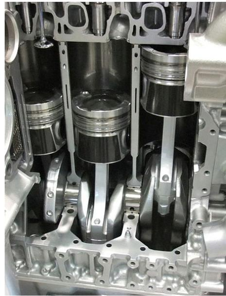
FIGURE 2.21 – Pistons et cylindres d'un moteur automobile découpé.
