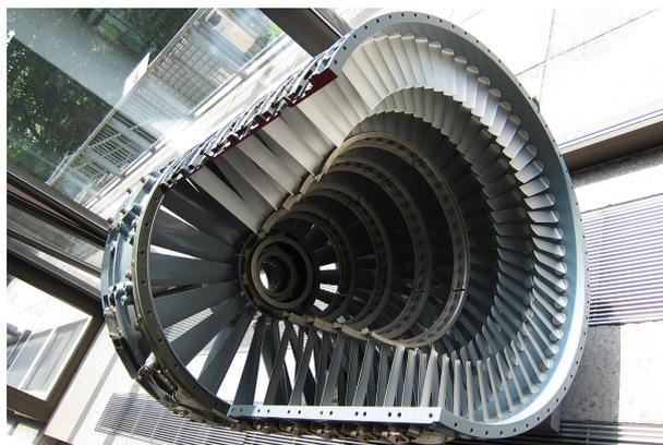
FIGURE 10.6 – Caisson de stators accueillant le compresseur axial d'un turboréacteur.
