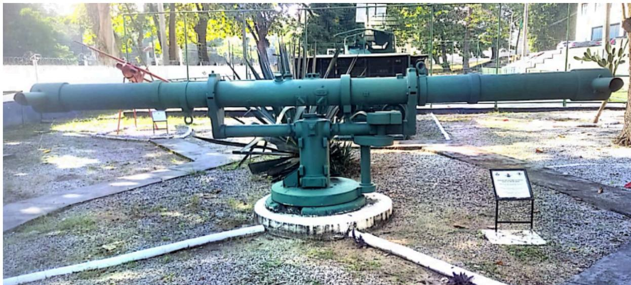
Telêmetro Estereoscópico Zeiss de seis metros de base.
