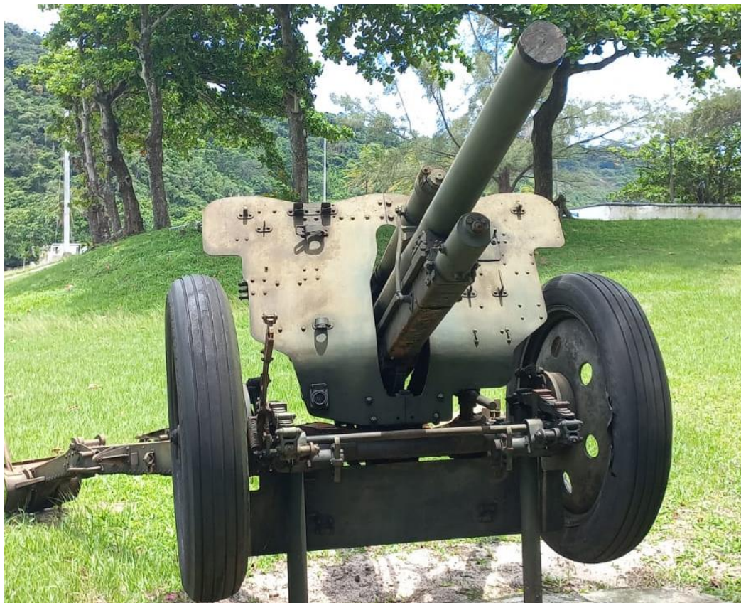
Figura 17 - Canhão Krupp 75 mm C/34. O canhão está com roda com pneus de borracha que foram colocados posteriormente pelo Arsenal de Guerra do Rio de Janeiro.
