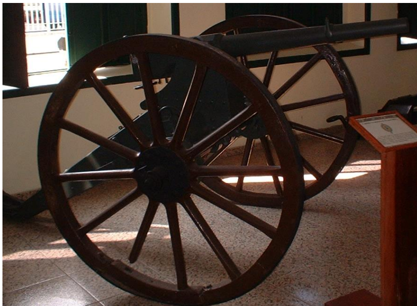
Figura 6 - Canhão Grusonwerk 53 mm L/30 de tiro rápido. Foi o primeiro canhão dessa modalidade adquirido pelo Exército junto à Krupp, mesmo vindo de uma filial recém-comprada.
