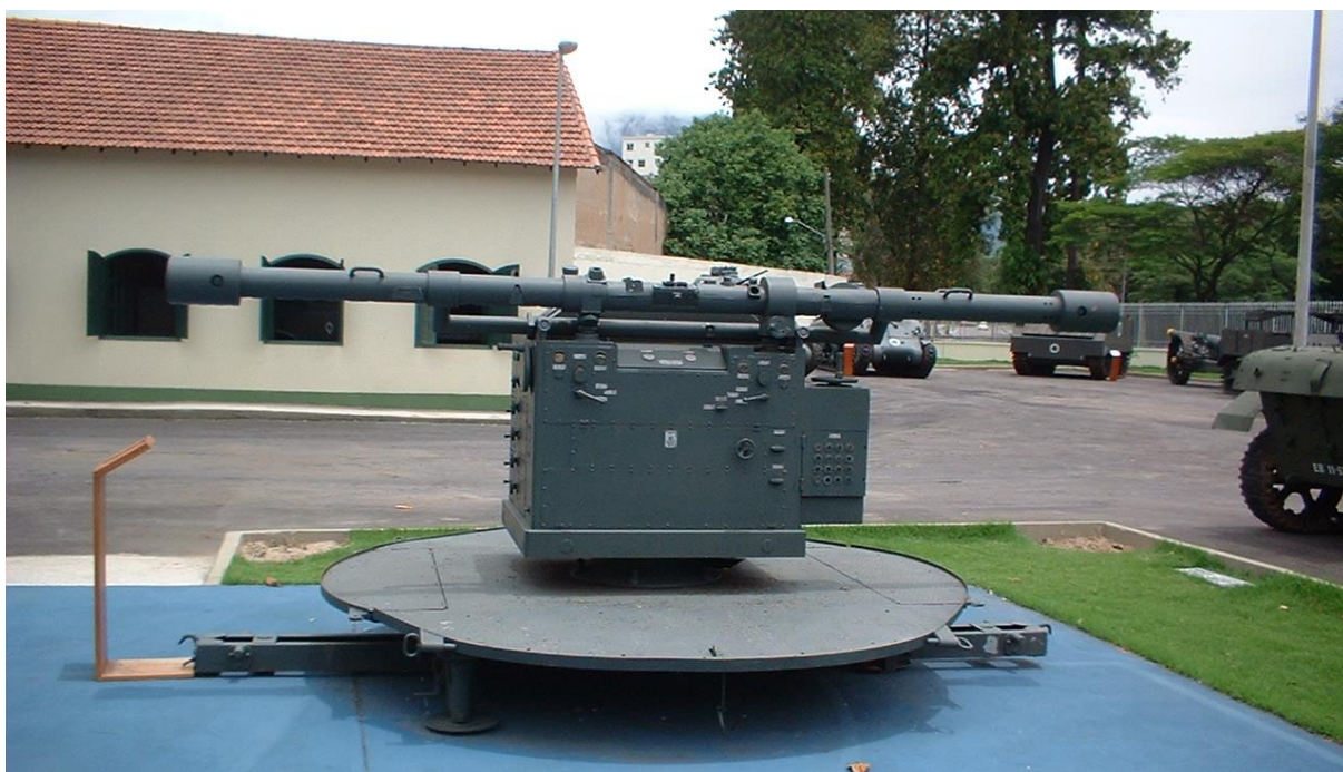
Figura 20 - Aparelho de Direção de Tiro (Preditor) WIKOG 9 SH. Fonte: Museu Conde de Linhares - Rio de Janeiro.
