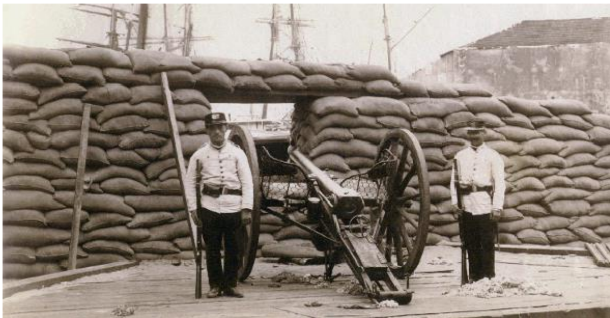
Figura 1 - Canhão Krupp 8 cm dado de presente ao Imperador do Brasil atuando na Revolta da Armada em 1895, junto à Docas Pedro II no Rio de Janeiro. Notam-se, na foto, 2 assentos ao lado do tubo para os serventes da peça, eles não existiam nos modelos vendidos ao Exército.
