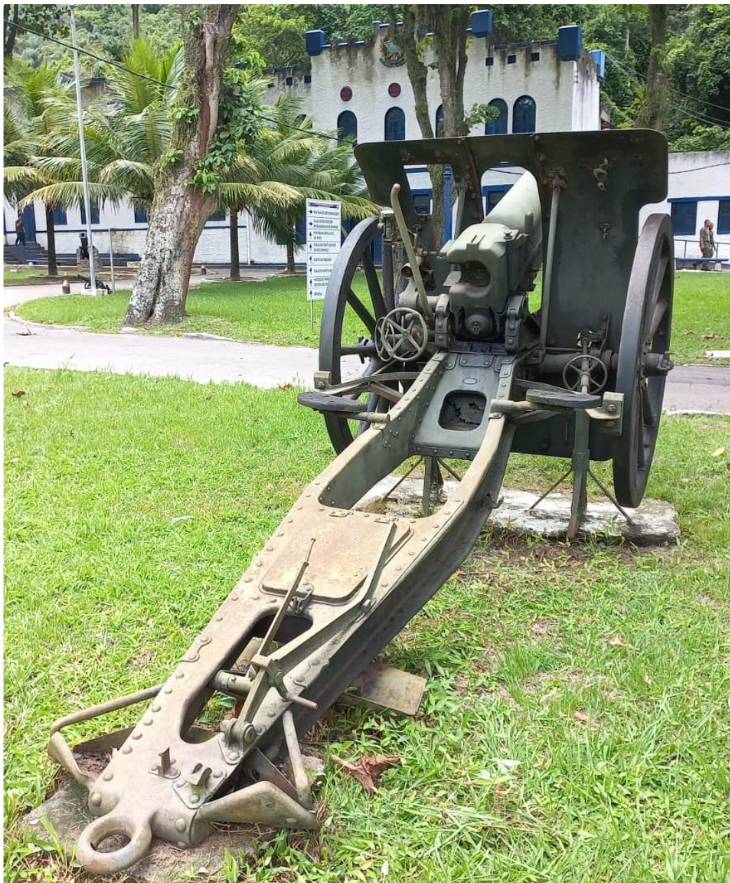
Figura 13 - Obus Krupp 105 mm L/14, tiro rápido, modelo 1906. Nota-se sua flecha única, construção que limitava a peça em atirar com maiores elevações e dava menos estabilidade após seu disparo.
