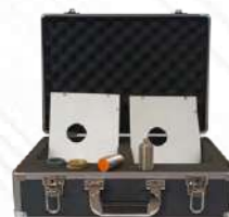
MDU-SD. Sensores de Desplazamiento para Equipo MDU
