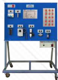
TEFA. Equipo de Fallos Eléctricos en Instalaciones de Aire Acondicionado
