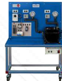
TECR. Equipo de Conexión Eléctrica de Compresores de Refrigerante
