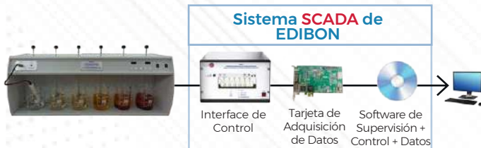
► PEFC. Equipo de Floculación, Controlado desde Computador (PC)
