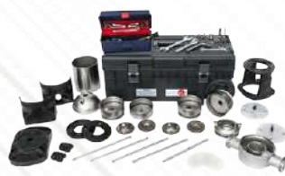
AMMCP. Equipo de Montaje y Mantenimiento de una Bomba Centrífuga Multitapa
