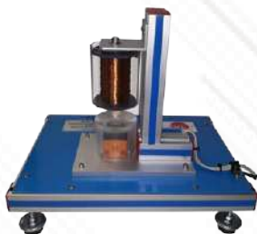
RYC-CLM. Módulo de Control de Levitación Magnética
