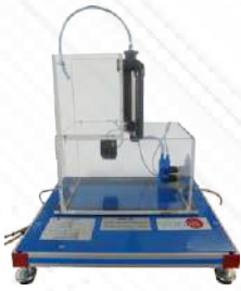
RYC-N. Módulo de Control de Nivel
