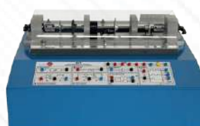
BS7. Módulo de Ensayos de Tacómetro
