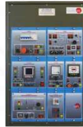
AEL-FUSC-N. Smart Grid (Usuario Final) - Aplicación de Net Metering
