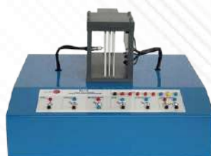
BS10. Módulo de Ensayos de Iluminación
