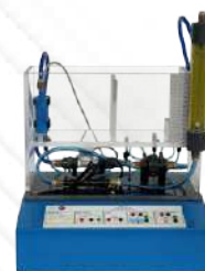
BS4. Módulo de Ensayos de Caudal
