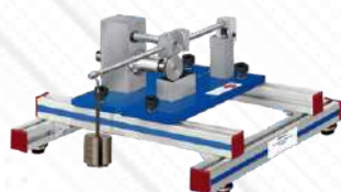
MEMT-4. Rozamiento por Rodadura en Ruedas
