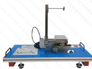
MEMT-2. Fricción dinámica de un Cilindro en un Rodillo
