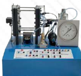
BS3. Módulo de Ensayos de Presión
