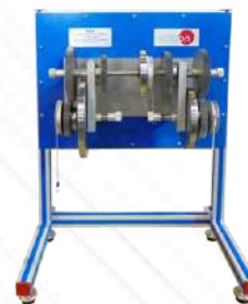
MCDA. Equipo de Montaje de Transmisiones Combinadas
