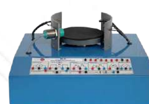
BS8. Módulo de Ensayos de Proximidad
