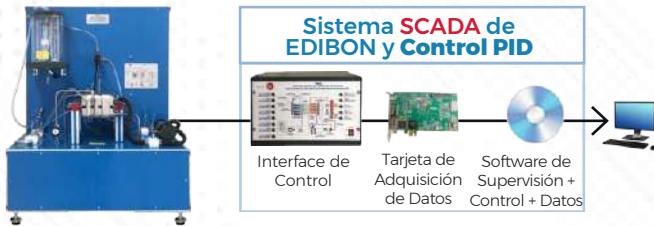
► PASC. Pasteurizador de Laboratorio, Controlado desde Computador (PC)
