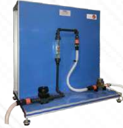
FME30/I. Caudalímetro Tipo Vortex
