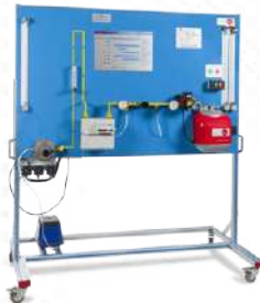
GBT. Equipo de Experimentación con Quemador de Gas de Tiro Forzado
