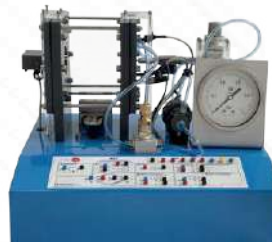
BS3. Módulo de Ensayos de Presión
