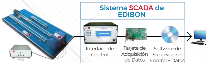
TIAC. Equipo para Estudio de Impedancia Acústica/ Aislamiento Acústico, Controlado desde Computador (PC)
