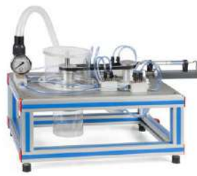
FME27. Turbina de Flujo Axial
