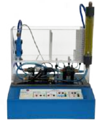
BS4. Módulo de Ensayos de Caudal
