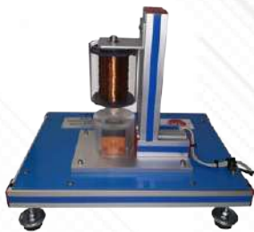
RYC-CLM. Módulo de Control de Levitación Magnética
