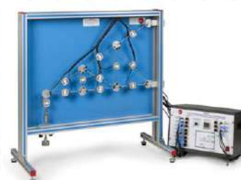
► MFCS1. Equipo de Estudio de Fuerzas en Diferentes Montajes de Celosías Planas
