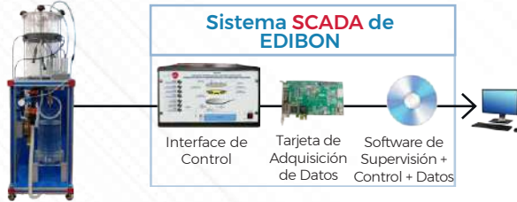
▶ PAHSC. Equipo de Succión de la Humedad del Suelo, Controlado desde Computador (PC)
