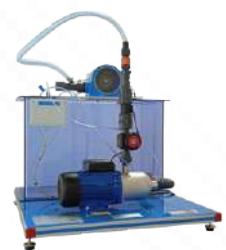
HT-P. Modelo de Turbina Pelton
