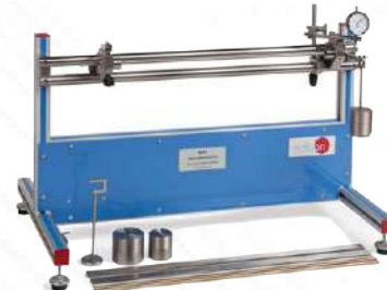
► MTT. Equipo de Prueba de Torsión (30Nm)
