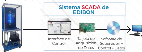
► POAC. Equipo de Oxidación Avanzada, Controlado desde Computador (PC)
