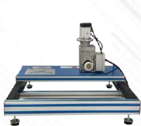
MEMT-UB. Equipo de Accionamiento para Ensayos Tribológicos
