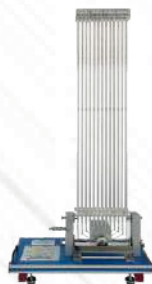
MEMT-1. Distribución de Presión Radial en un Cojinete de Deslizamiento
