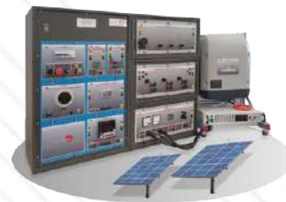
PWP-PE. Planta de Potencia de Energía Fotovoltaica
