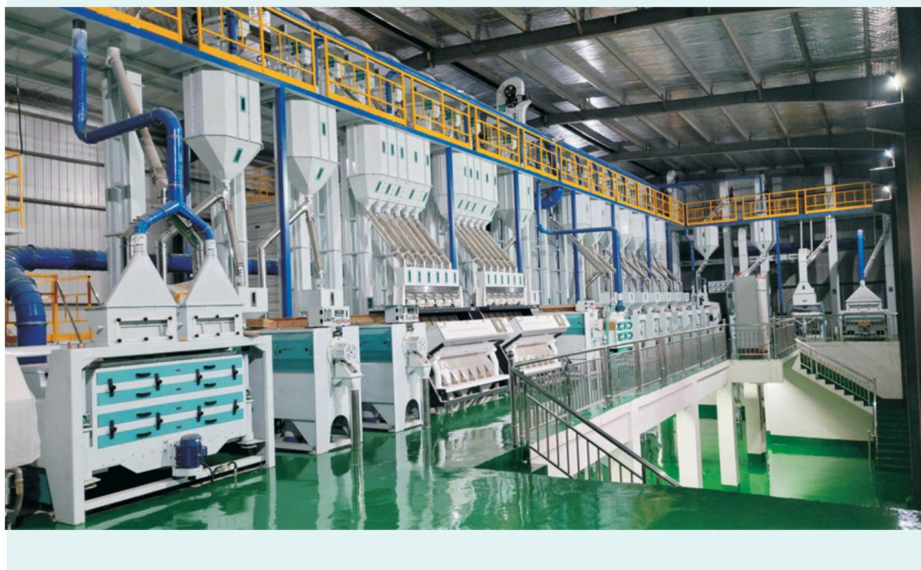
华北日产150吨大米成套自动化碾米工程
