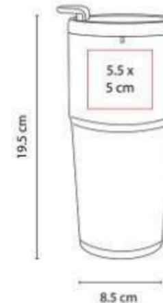
Doble pared. Pared interior acero inoxidable, pared exterior plástico. Tapa de plástico en dos posiciones.
