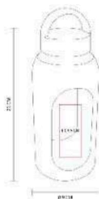
Cilindro de vidrio con manga de silicon graduada en ml. Tapa de plástico con sistema de rosca y asa.
