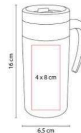
Doble pared. Pared interna plástico, pared externa acero inoxidable. Tapa de plástico con válvula de seguridad.
