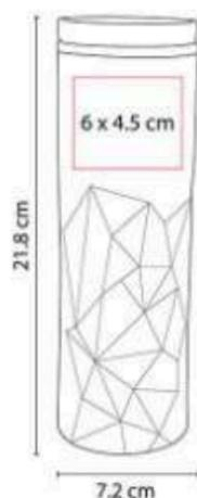
Doble pared. Pared interna plástico, pared externa acero inoxidable. Cuerpo prismático.
