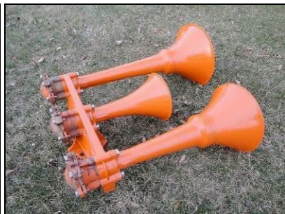
S-3L de 1952 ou 1953, sem as marcas "Leslie" e "SuperTyfon", com manifold baixo
