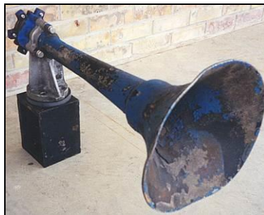
S-25 antiga, com câmara de bronze tab-back e corneta em 2 partes
