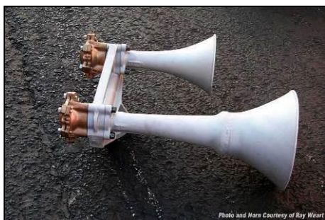
S-2M com corneta #31 bipartida e câmaras de bronze, e S-2M com corneta #31 em peça única
