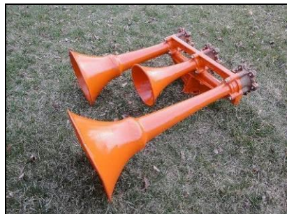
S-3L de 1952 ou 1953, sem as marcas "Leslie" e "SuperTyfon", com manifold baixo
