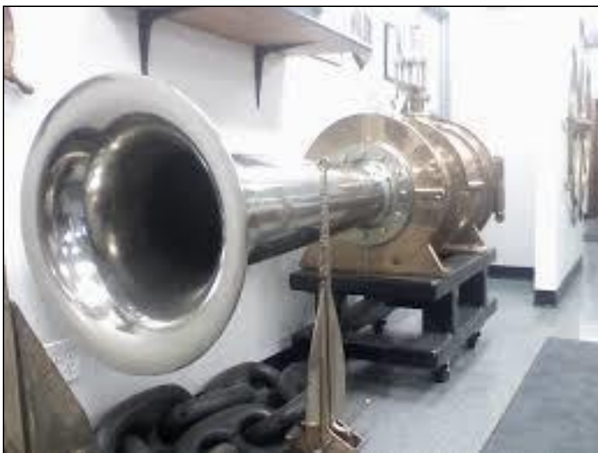
Leslie Tyfon TA-575-DVE restaurada, pesando de mais de 1t, chamada foghorn ; 575 refere-se ao diâmetro do diafragma em mm Essa buzina foi produzida pela Kockums para o navio Queen Mary
