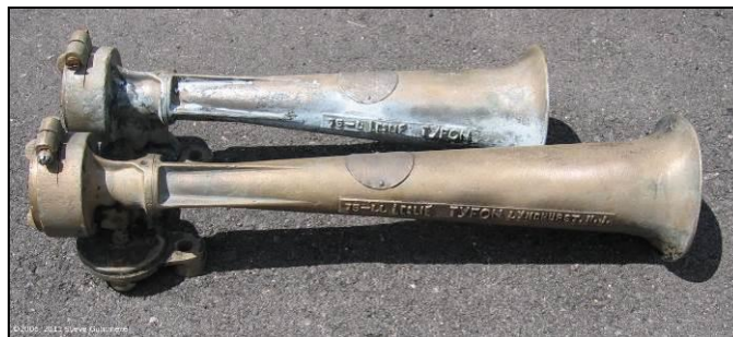
rara buzina A-75 de 2 tons, com cornetas A75-L e A-75-LL
