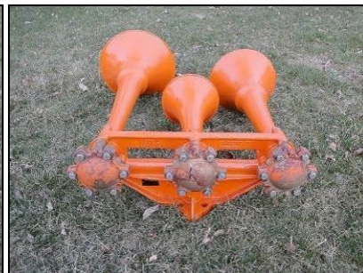
S-3L de 1952 ou 1953, sem as marcas "Leslie" e "SuperTyfon", com manifold baixo
