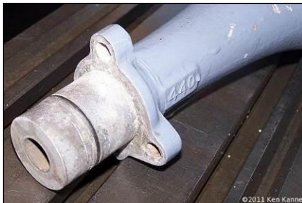
corneta #440 com o-ring e marca de fundição; marcas de fundição de uma #25 antiga mostrando os logos Leslie e SuperTyfon e a marca ®
