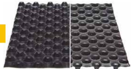
Lamina drenante SUIDRENTEX fabricada con polietileno de alta densidad y geotextil de polipropileno con nódulos troncocónicos de 7 mm. Lámina drenante de 400 g/m<sup>2</sup> y geotextil de polipropileno de 100g/m<sup>2</sup>.
