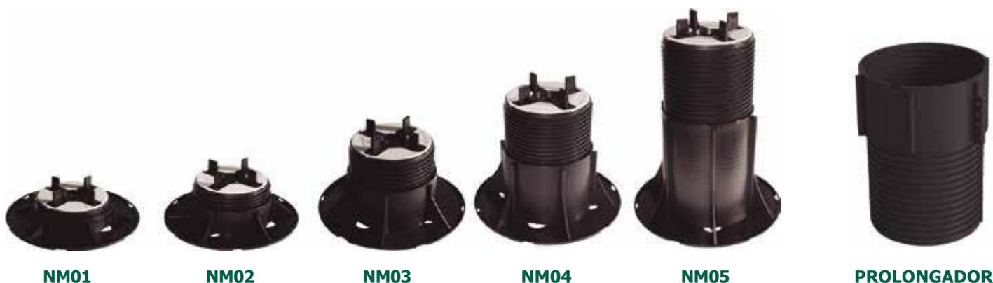
La combinación de los 5 soportes con el prolongador NM de 165 mm de altura, nos permite llegar hasta una altura de 990 mm.
