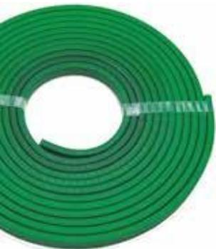
Perfil hidroexpansivo color verde, a base polietileno, caucho butílico y resinas elastoméricas, **sin bentonita**, para juntas de trabajo o estanqueidad. Gracias a su composición química el perfil cuando esta en contacto permanente con el agua, se expande de forma gradual, creando una barrera contra la presión del agua tanto positiva como negativa.
