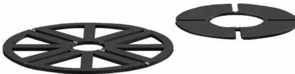
Los niveladores pueden compensar de 1 a 3 mm de espesor y pueden colocarse en las cabezas de los soportes PR, SE, NM, ST y EH.
