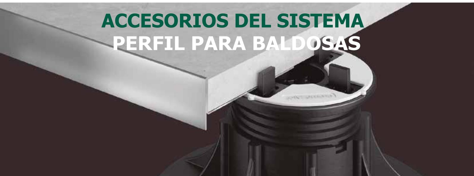
El perfil de acabado para baldosas "Plate Edge Profile" está diseñado para limitar el borde del suelo elevado cuando se encuentra con un cerramiento vertical. El "Plate Edge Profile" tiene una parte decorativa de 30 mm. Está disponible en tres modelos: en acero inoxidable, en aluminio y en acero pintado RAL 7043.
