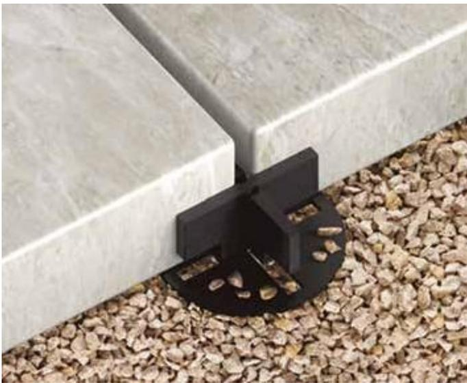
El Mini DM Spacer permite colocar baldosas de forma rápida y efectiva sobre arena, grava o césped, asegurando la máxima estabilidad y el espaciado preciso entre las baldosas. El Mini DM Spacer es un componente muy simple pero versátil con cuatro aletas en forma de cruz, una mini base y una espiga de seguridad de 45 mm de largo.
