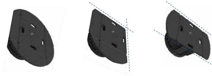
Las bases de los soportes PRIME, NM y SE tienen 4 líneas premarcadas, que permiten recortar fácilmente la base para adaptarse a las esquinas cortando el soporte en ángulo de 90°, o adaptarse al muro perimetral cortando la base por un lado. También se recorta la base cuando la distancia entre soportes es inferior a 20 cm.
