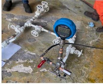
+ Los manómetros Marca ADDITEL , con informe de calibración, ema vigente.
