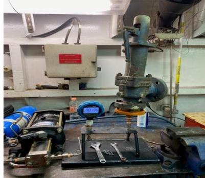
Prueba con bomba booster de alta presión
