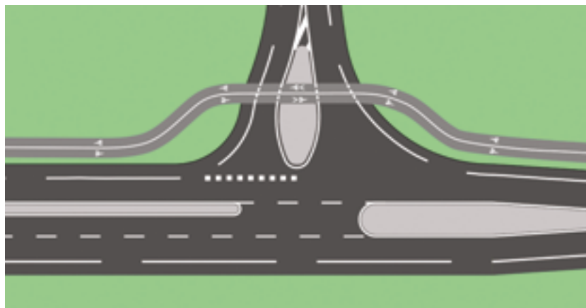
Figure 26 : Franchissement dans l'îlot directionnel du carrefour plan ordinaire par un aménagement cyclable hors largeur roulable
