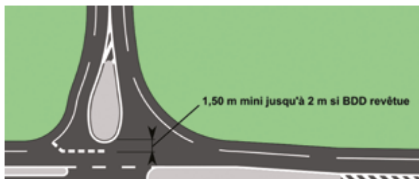
Figure 25 : Position de la pointe de la partie en saillie de l'îlot séparateur par rapport à la voie et la BDD
