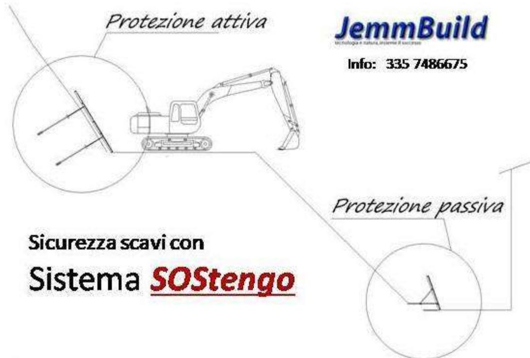
Nel campo della sicurezza risulta molto utile nella **protezione dei fronti di scavo**, sia in conformazione **attiva**, tramite l'uso di tiranti, che **passiva**, svolgendo nel contempo la funzione di recinzione temporanea.
