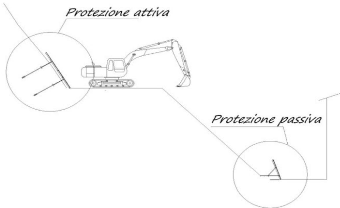
Nel campo della sicurezza risulta molto utile nella **protezione dei fronti di scavo**, sia in conformazione **attiva**, tramite l'uso di tiranti, che **passiva**, svolgendo nel contempo la funzione di recinzione temporanea.
