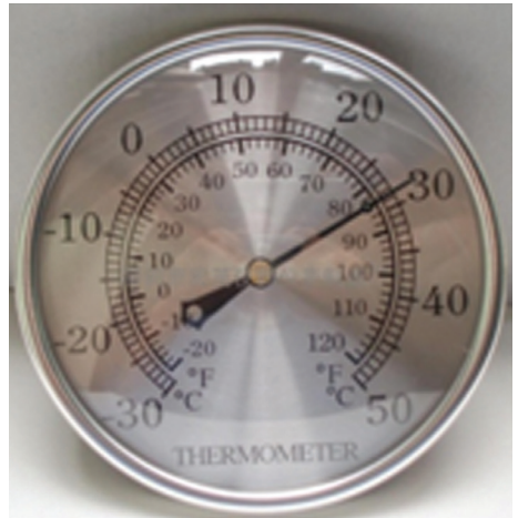
Gambar 4.7 Termometer bimetal, digunakan untuk mengukur suhu
