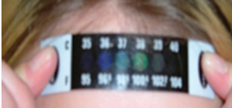
Gambar 4.8 Termometer kristal cair untuk mengukur suhu tubuh.
