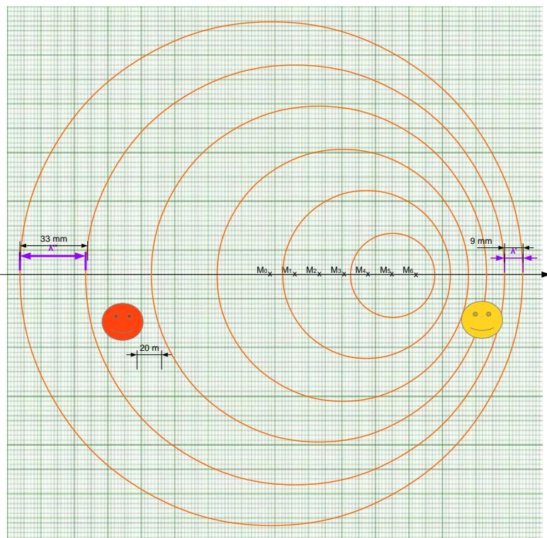
3. À l'avant, les ondes sont périodiques et plus resserrées qu'en arrière de l'avion.  $\lambda' < \lambda''$
