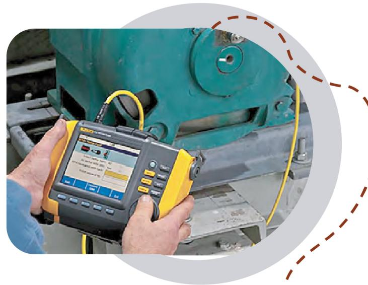
*El análisis de vibraciones es la principal técnica para supervisar y diagnosticar la maquinaria rotativa e implantar un plan de mantenimiento predictivo.*
