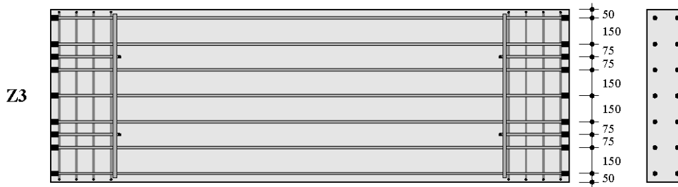
Bild A-6: Bewehrungsführung des Versuchskörpers Z3 (aus [2])
