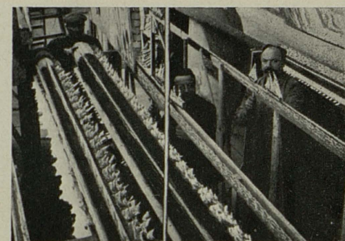
Imitation de la mer à l'aide de cylindres portant des silhouettes de vagues.
