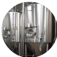
Cuve de fermentation cylindro-coniques
