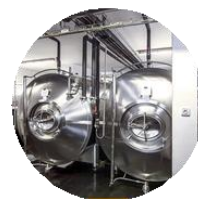
Cuve de garde
